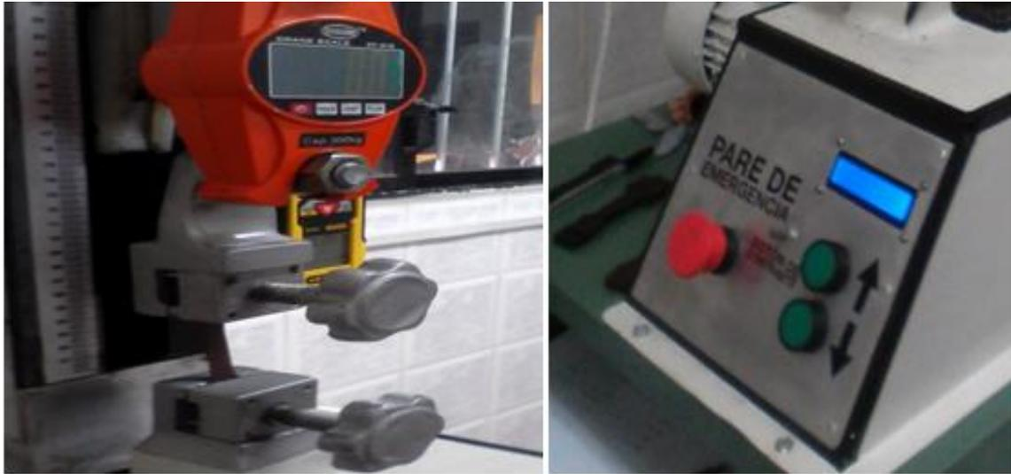
**Fotografía 1-2:** Partes de un equipo para realizar la medición de la resistencia al frote en seco.
