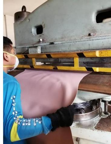
Prensado a 100 °C, por 4 segundos y 200 Bar de presión
