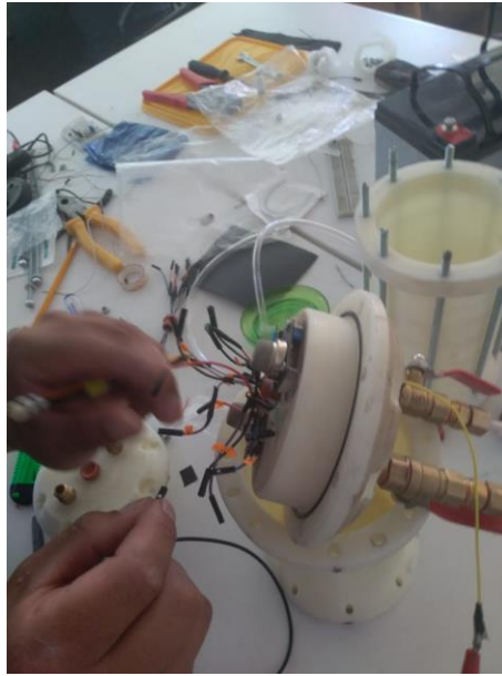
Figura 10-3 Instalación del sistema de recolección de datos (sensores) en la cabeza del reactor.
