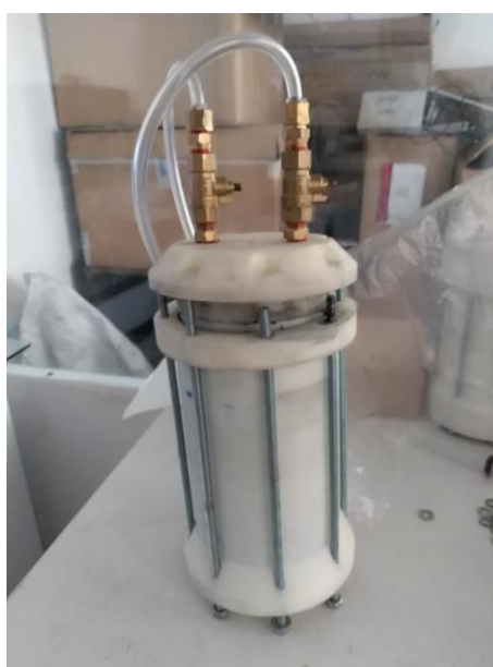
Figura 9-3 Cuerpo del reactor con los accesorios para la hermeticidad de la cabeza del prototipo.
