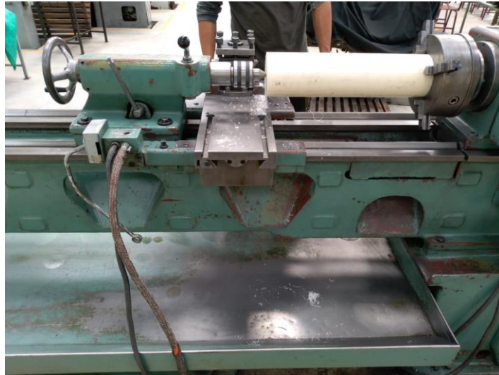
Figura 6-3 Proceso de mecanizado del cuerpo principal del reactor prototipo.
