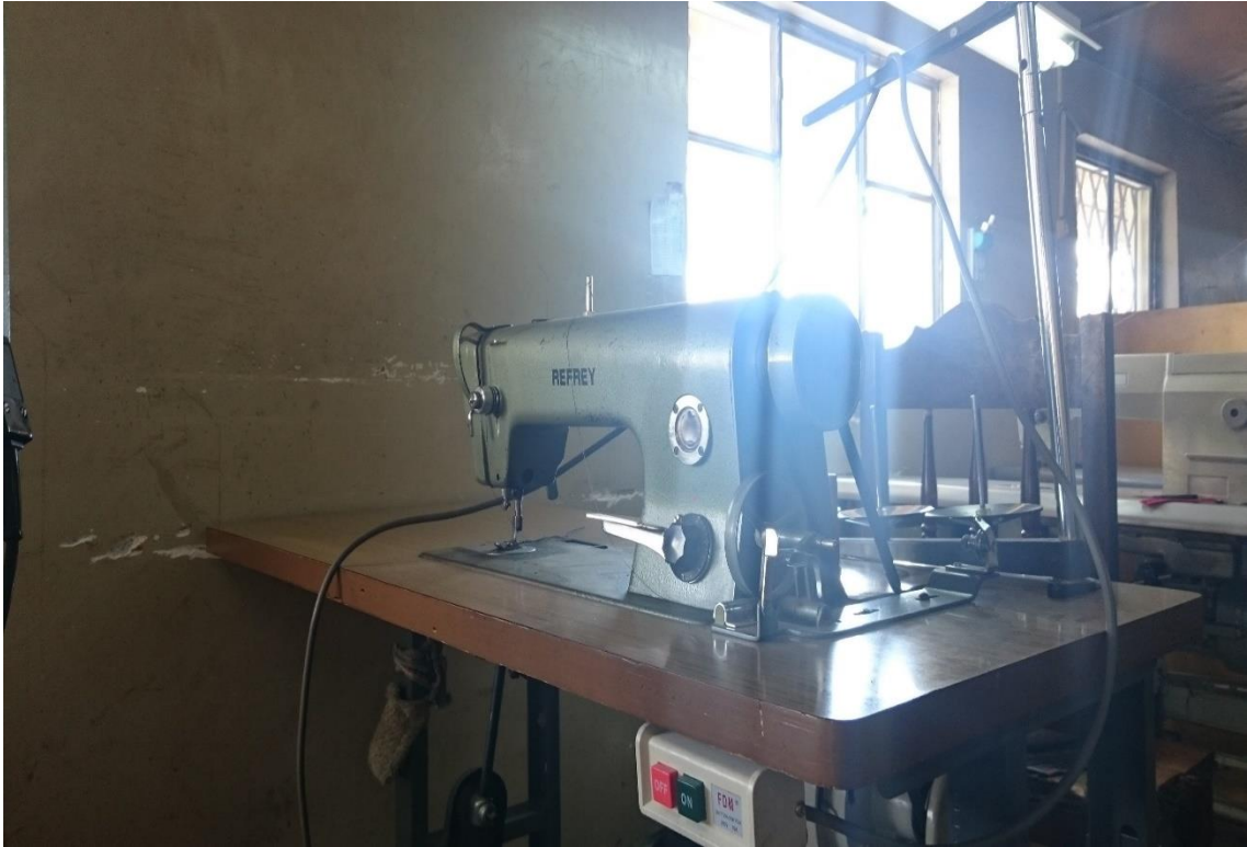
La máquina looper se utiliza para el pegado de cuellos y vinchas en los suéteres
