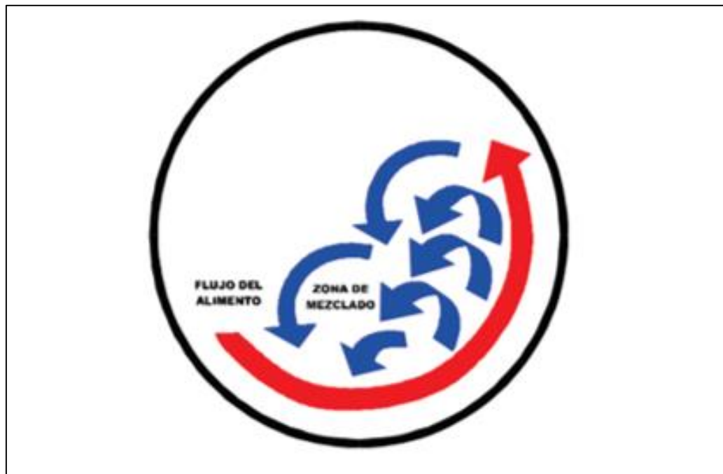
Figura 3-1. Patrón de mezclado de mezcladoras de tambor.
