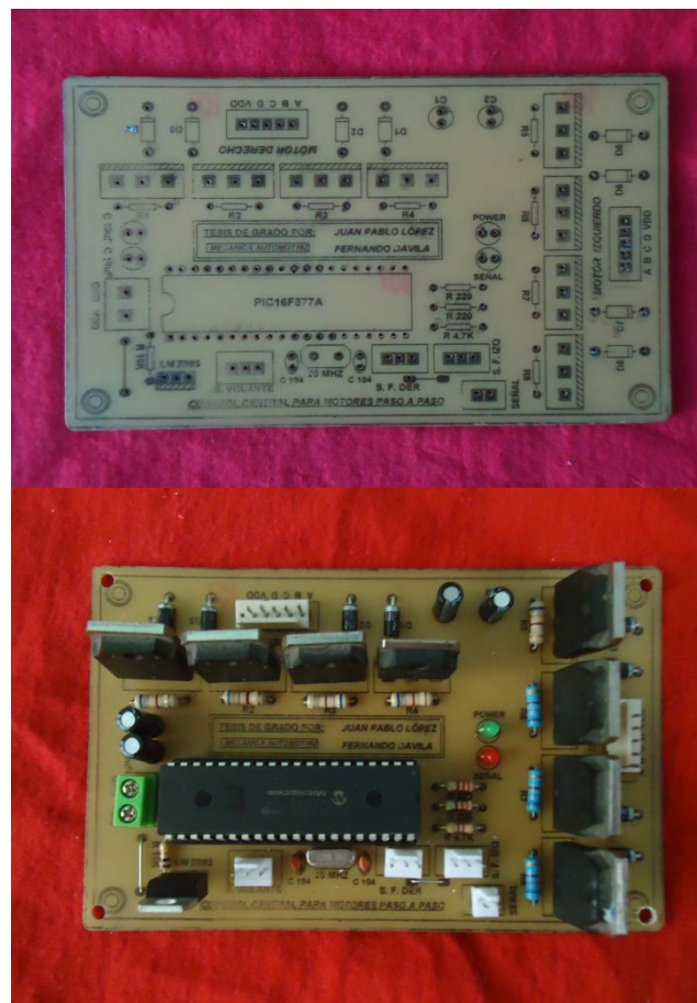
Figura 5.48. Placa electrónica terminada
