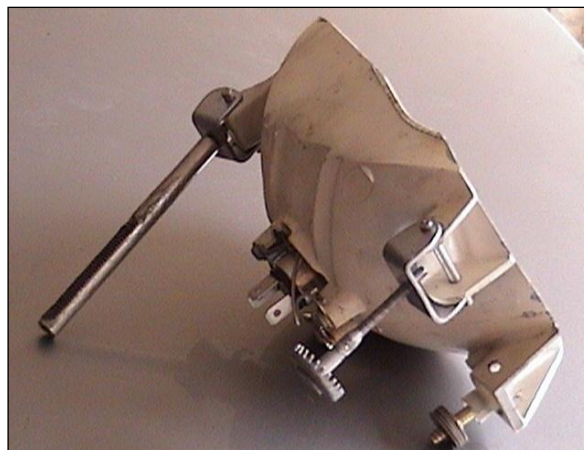
Figura 4.16. Mecanismo interno del faro
