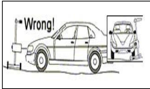
Figura 2.29. Nivelación incorrecta del piso para alinear faros
