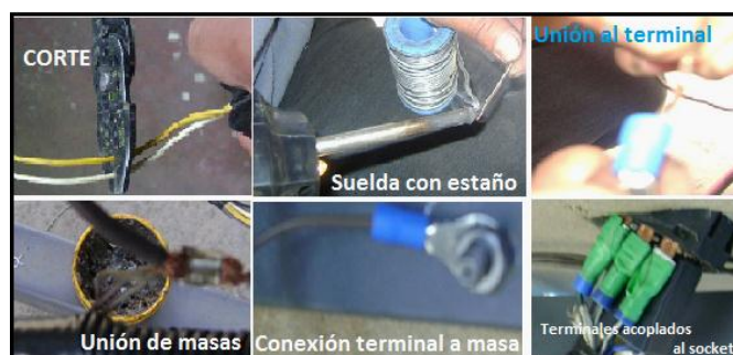
Figura 4.4. Ensamble de cableado a sus terminales
