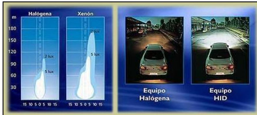
Figura 2.19. Alcance del haz de luz de una lámpara de gas o luz xenón
