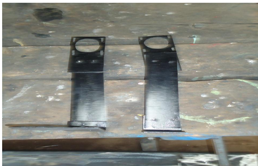
Figura 5.30. Soportes de motor terminados
