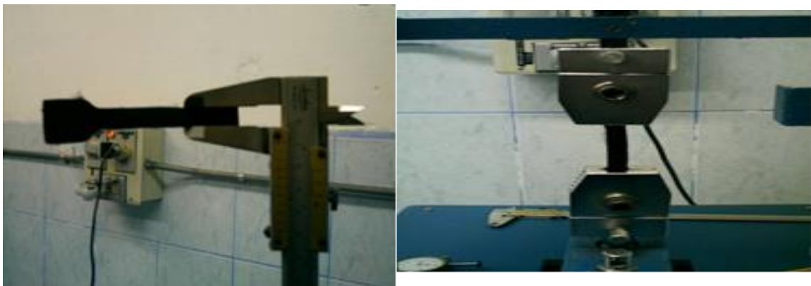
Fotografía 3-2: Medición de la longitud inicial del cuero.
