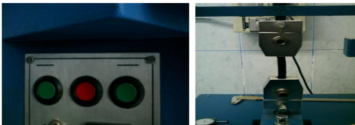
Fotografía 5-2: Puesta en marcha del prototipo mecánico para medir la resistencia a la tensión.
