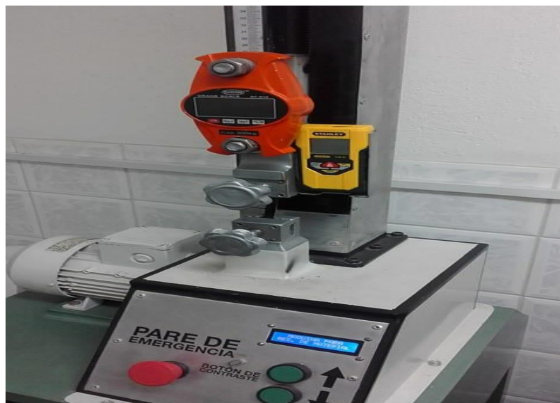
Fotografía 1-2: Partes de un equipo para realizar la medición de la resistencia a la tensión el cuero.
