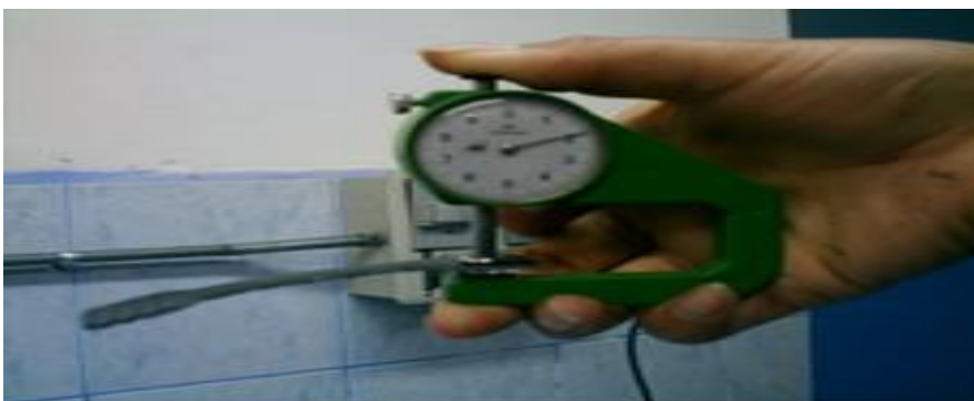
Fotografía 3-2: Equipo para medir el calibre del cuero.
