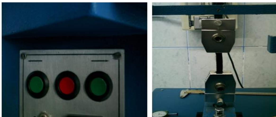
Fotografía 7-2: Puesta en marcha del prototipo mecánico para medir la resistencia a la tensión del cuero. Fuente: (Laboratorio de Curtiembre de Pieles, 2019).
