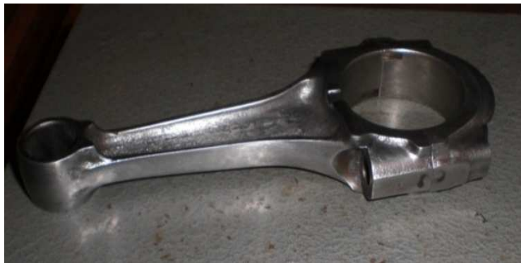
Figura 4.12: Pulido de la biela.
