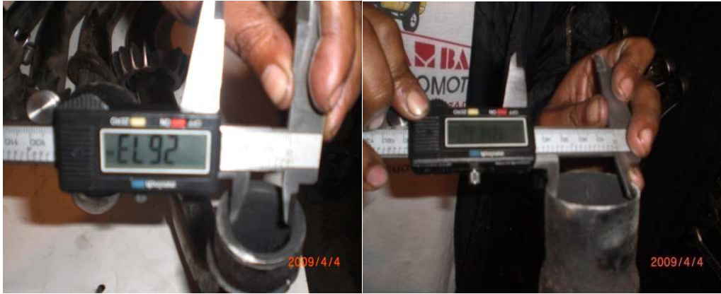
Figura 3.9: Medidas del tubo de escape
