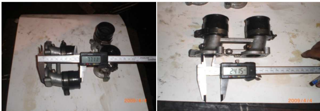
Figura 3.8: Medidas del colector de admisión
