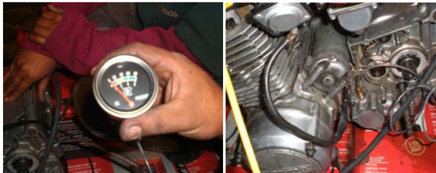
Figura 3.4: Medición de la presión de aceite
