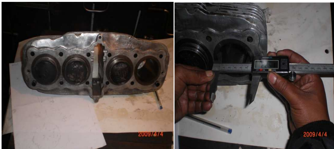
Figura 3.11: Medida del cilindro
