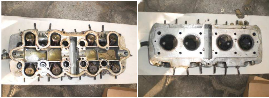
Figura: Desmontaje del árbol de levas y culata
