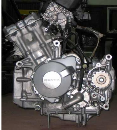
Figura 2.1: Motor de cuatro cilindros (HONDA CB550)
