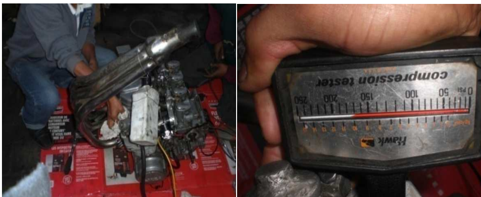
Figura 3.1: Toma de medidas de compresión
