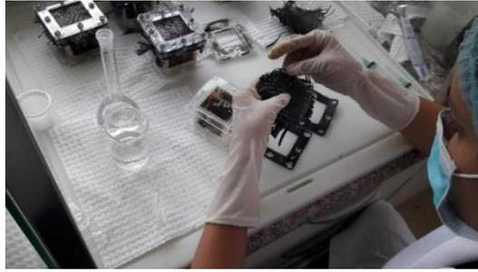
**Figura 7-2:** Inoculación de suelo en la celda
