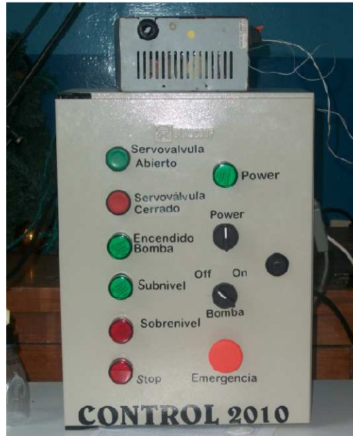
Figura V.22: Partes constitutivas del panel del operador
