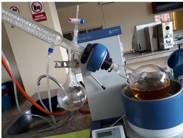
**Figura 3-5.** Separación de extracto y disolvente en el rotavapor
