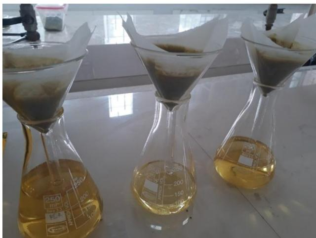
**Figura 3-4.** Filtración de solvente con extracto
