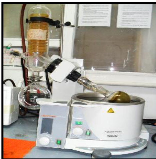
Figura 7-1. Concentración de extractos al vacío (Rotaevaporador)
