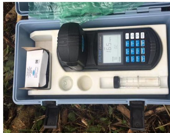
DR/890 Colorimeter (Análisis de Oxígeno Disuelto)
