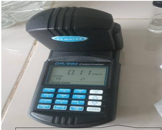
DR/890 Colorimeter (Análisis de Hierro y Sulfatos)
