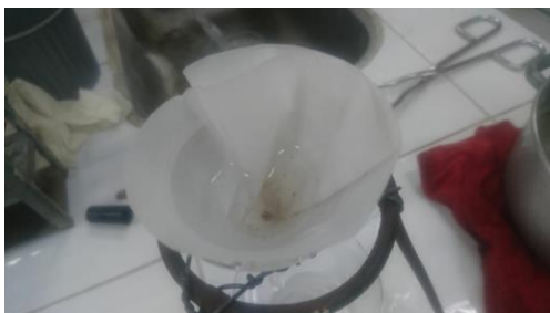
Filtración de cenizas totales para obtener cenizas solubles en agua
