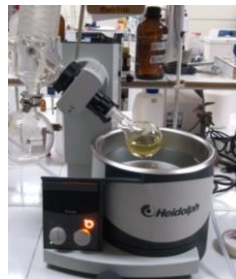
Concentración del extracto bruto de alcaloides en rotavapor por presión reducida a 50°C
