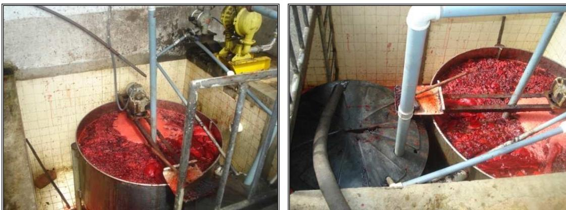
**FOTOGRAFÍA No 13. TANQUE DE RECOLECCIÓN DE LA SANGRE Y FUNCIONAMIENTO DEL AGITADOR PARA RUPTURA DE COÁGULOS.**
