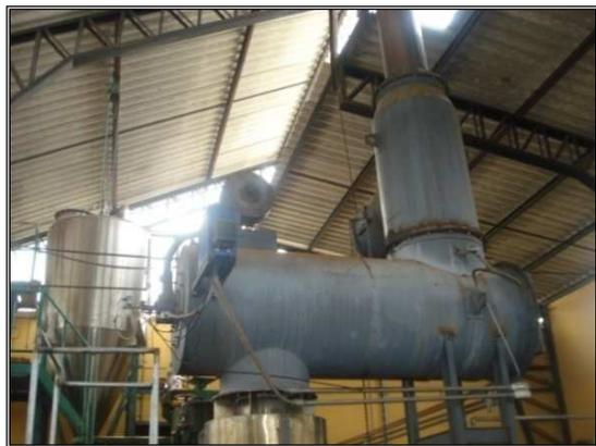
**FOTOGRAFÍA No 14. TANQUE DE EVAPORACIÓN Y TANQUE DE INCINERACIÓN**
