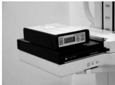
**Figura 3.3:** Kilovoltímetro colocado para medir la reproducibilidad y desviación de la tensión
