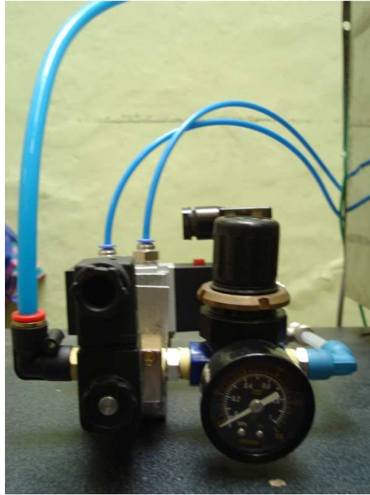
Figura II.10. Válvulas del módulo de temperatura
