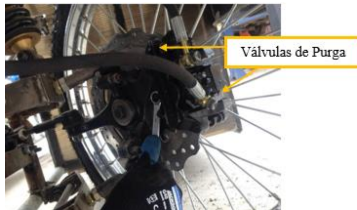
Figura 1-4: Purgado del sistema hidráulico.
