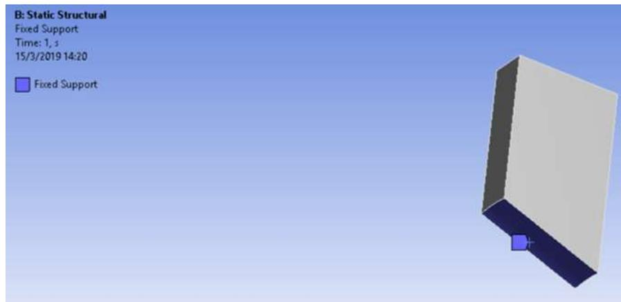
**Figura 29-3:** Soportes en la cuchilla.
