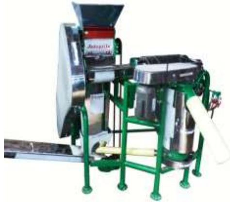
**Figura 3-2:** Despulpadora de tornillo referencia 300.
