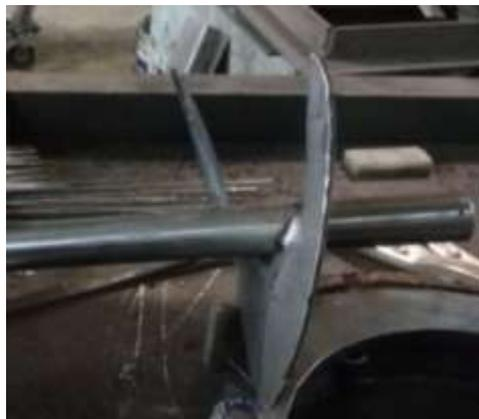
**Figura 96-3:** Tornillo sinfín soldado en el eje principal.
