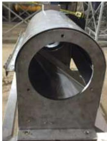
**Figura 90-3:** Brida de soporte con 3 perforaciones.
