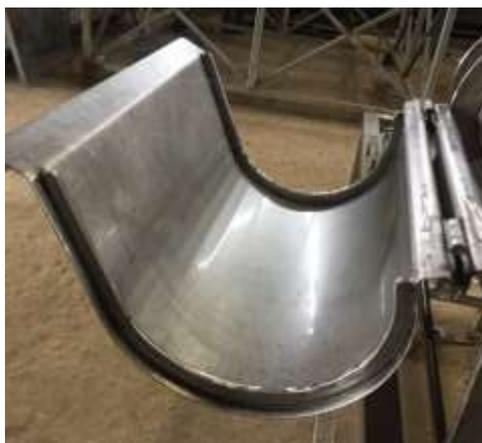
**Figura 92-3:** Cubierta con refuerzos.
