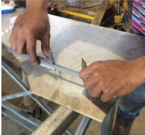
**Figura 88-3:** Trazo en plancha de 8mm para construcción de bridas.
