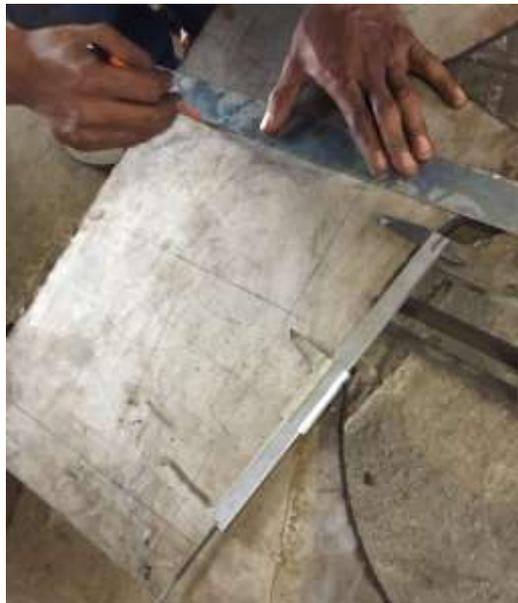
**Figura 84-3:** Trazos en plancha de 2mm para piezas de tolva.
