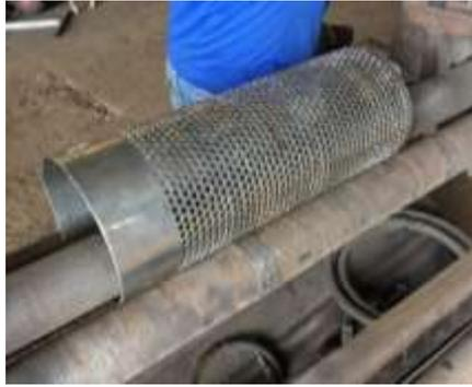
**Figura 86-3:** Proceso de rolado para la construcción del tamiz.
