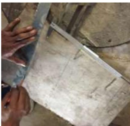
**Figura 93-3:** Trazos en plancha de 2mm para construcción bandeja de salida pulpa.
