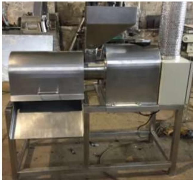
**Figura 82-3:** Máquina despulpadora de guanábana.
