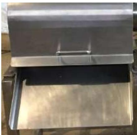
**Figura 103-3:** Descarga de la pulpa.
