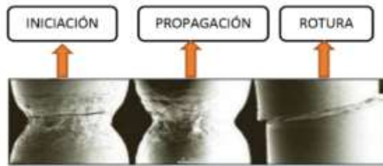
Figura: 1-2: Fases de falla por fatiga
