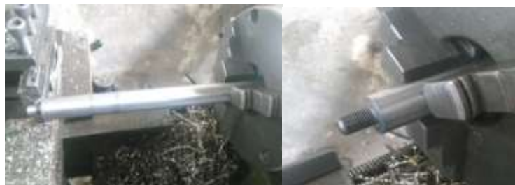
Figura 24-3: Fabricación del eje motriz
