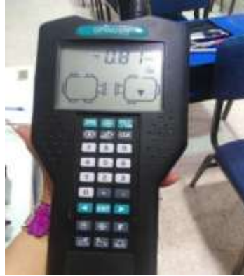
Figura 48-3: Desalineación total en el punto F
