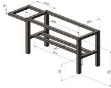
Figura 23-3: Medidas y forma de la estructura
