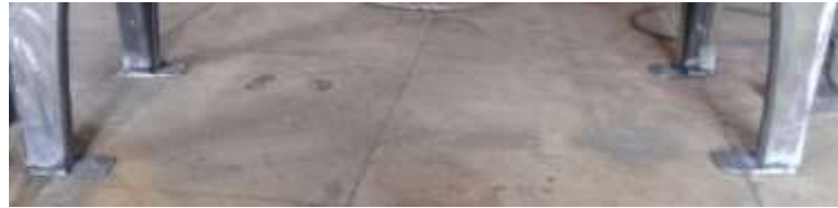
Figura 34-3: Fabricación de las placas base de la máquina
