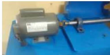
Figura 39-3: Montaje del motor con el eje conductor
