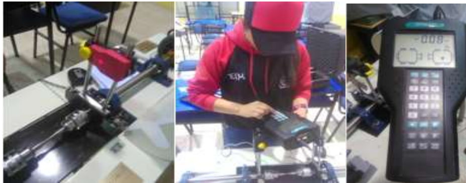
Figura 50-3: Alineación con el OptalignPlus
