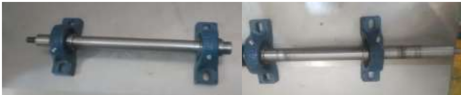
Figura 36-3: Montaje de los ejes en las chumaceras
