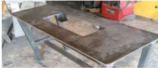
Figura 28-3: Fabricación de la placa de soporte principal
