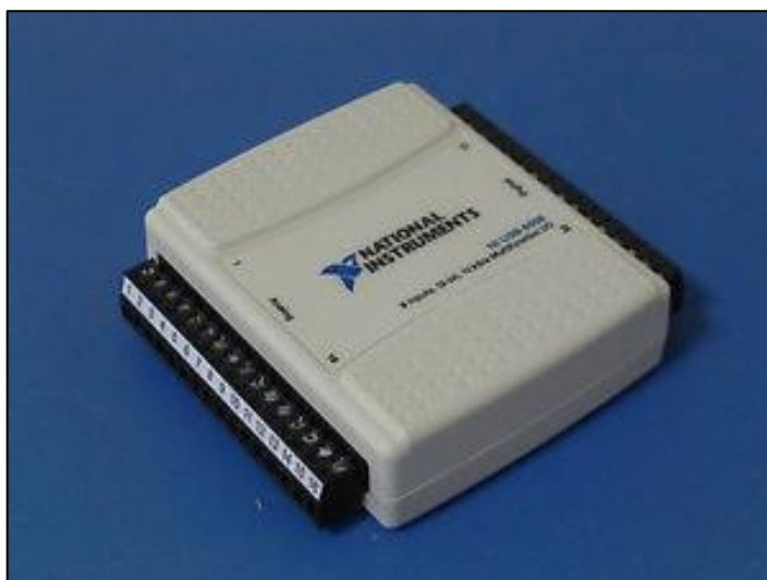
Figura 1-3: Tarjeta de adquisición de datos DAQ 6009.
