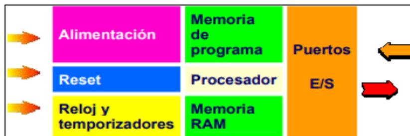
**Figura 68-2:** Representación esquemática del microcontrolador.
