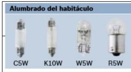
**Figura 56-2:** Lámparas usadas para la luz de salón
