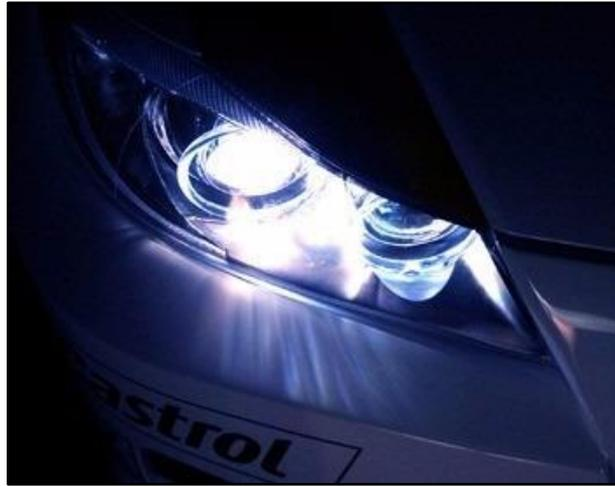
**Figura 8-2:** Lámpara de descarga de alta intensidad
