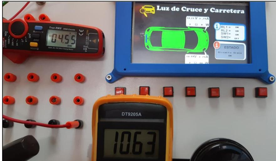
**Figura 49-3:** Medición de voltaje y corriente de la luz de carretera
