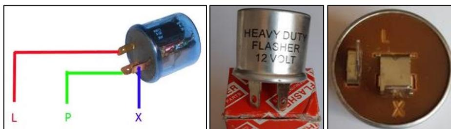
**Figura 34-2:** Pines de conexión del Flasher
