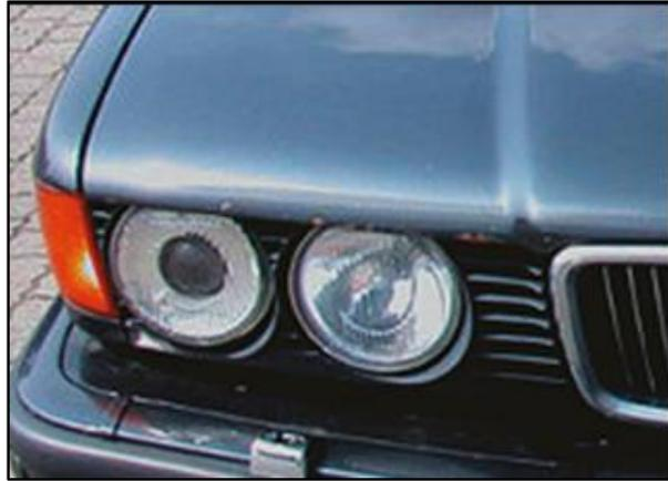
**Figura 6-2:** Primeras lámparas de descarga de gas xenón
