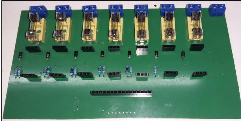
**Figura 41-3:** Implementación física de placas de control
