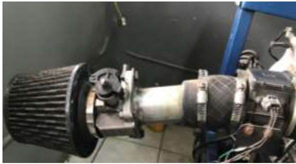
Figura 20-4: Instalación del equipo con el depurador
