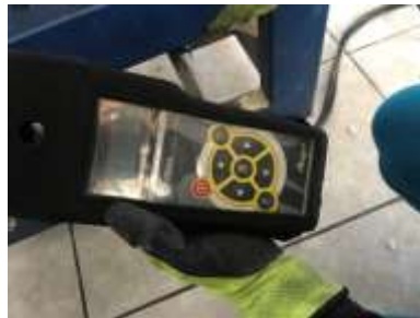
Figura 10-4 Pruebas de medición vibrachek
