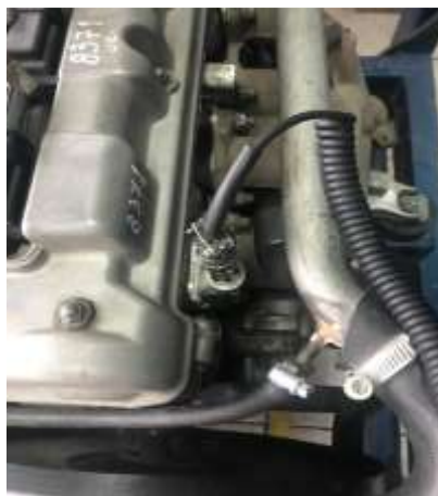
Figura 11-4: Acelerómetro en el punto 1
