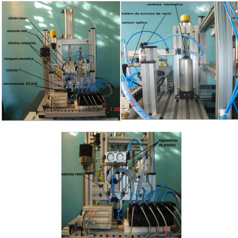
Figura VI. 45. Sistema de manipulación del pick and place
