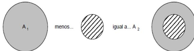
Figura III. 13. Diferencia entre las secciones efectivas de un cilindro.
