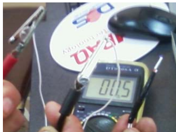
Figura 3.2: Continuidad del sensor RTD
