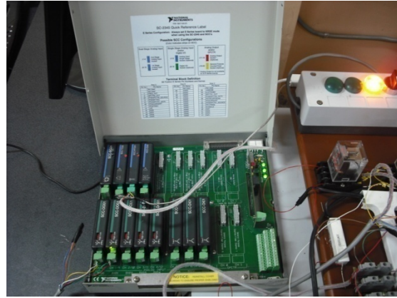
Figura 3.29: Funcionamiento circuitos eléctricos con el chasis SC-2345
