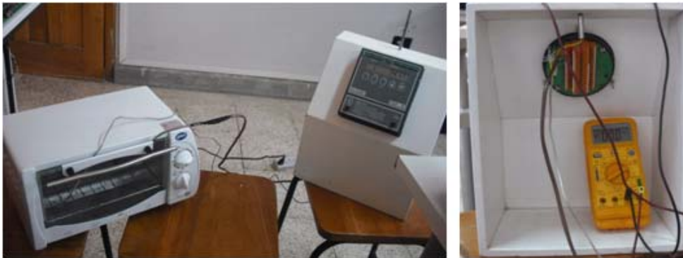
Figura 3.4: Comprobación del sensor con el indicador de temperatura
