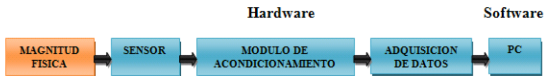
Figura 2.29: Diagrama de bloques general de medición
