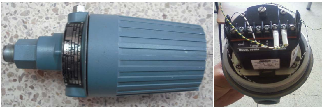
Figura 2.36: Transmisor de temperatura
