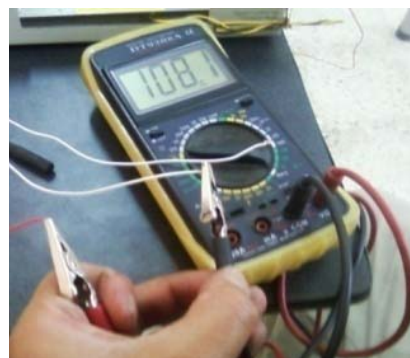
Figura 3.3: Comprobación de la resistencia del sensor RTD
