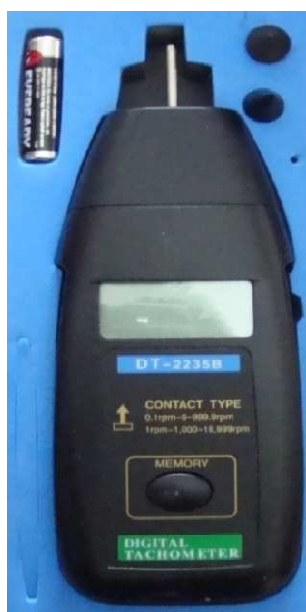
Figura 5.16: Tacómetro Digital DT – 2235B
