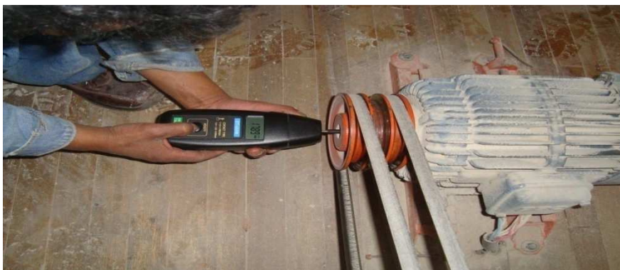
Figura 5.19: Toma de datos velocidad rpm Ventilador Ciclón
