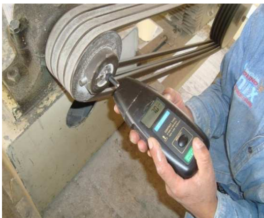
Figura 5.18: Toma de datos velocidad rpm Ventilador Sistema de Aspiración de Harina
