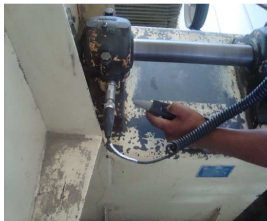
Figura 5.18: Toma de datos velocidad rpm Ventilador Sistema de Aspiración de Harina
