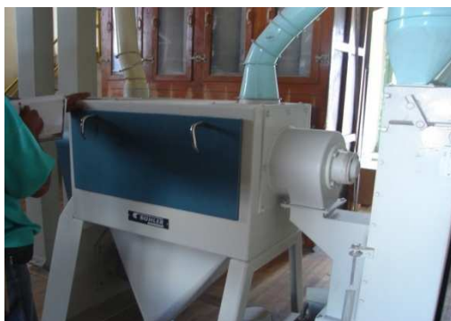
Figura 3.7: Despiedradora, y Ciclón (Sistema de limpieza)
