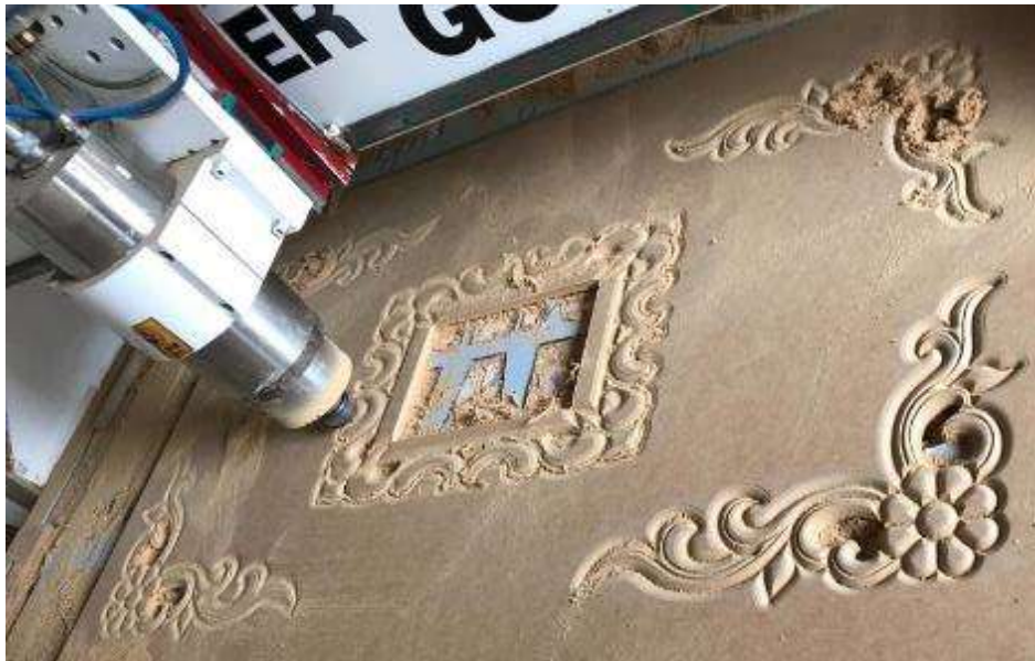
Figura 31-2: Prueba con madera suave MDF.
