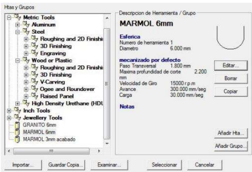
Figura 36-2: Datos cuchilla de 6 mm para desbaste en mármol.
