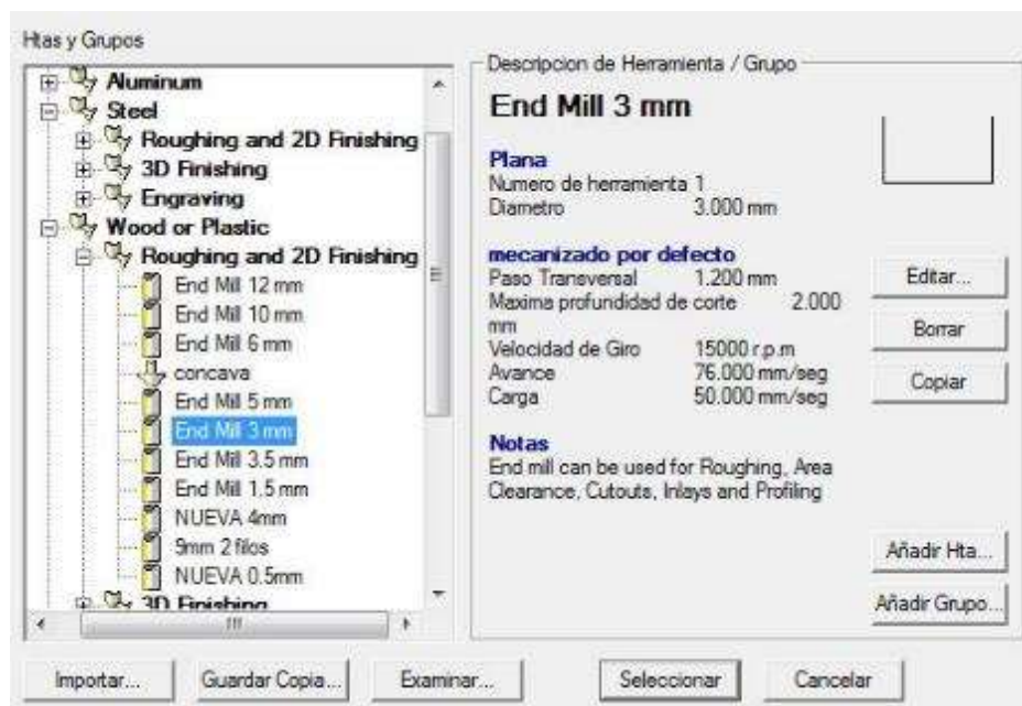
Figura 34-2: Datos cuchilla de 3 mm para desbaste en madera.
