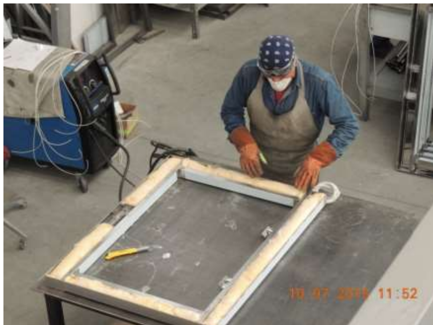
Gráfico 17: Ensamblaje mecánico de cámara interior
