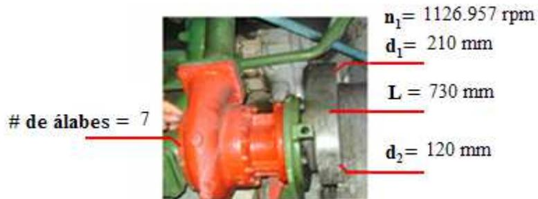
**Figura 5.1:** Ilustración de los Datos Técnicos de la Bomba de Polea
