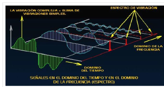
**Figura 2.4:** Formación del Espectro de Vibración
