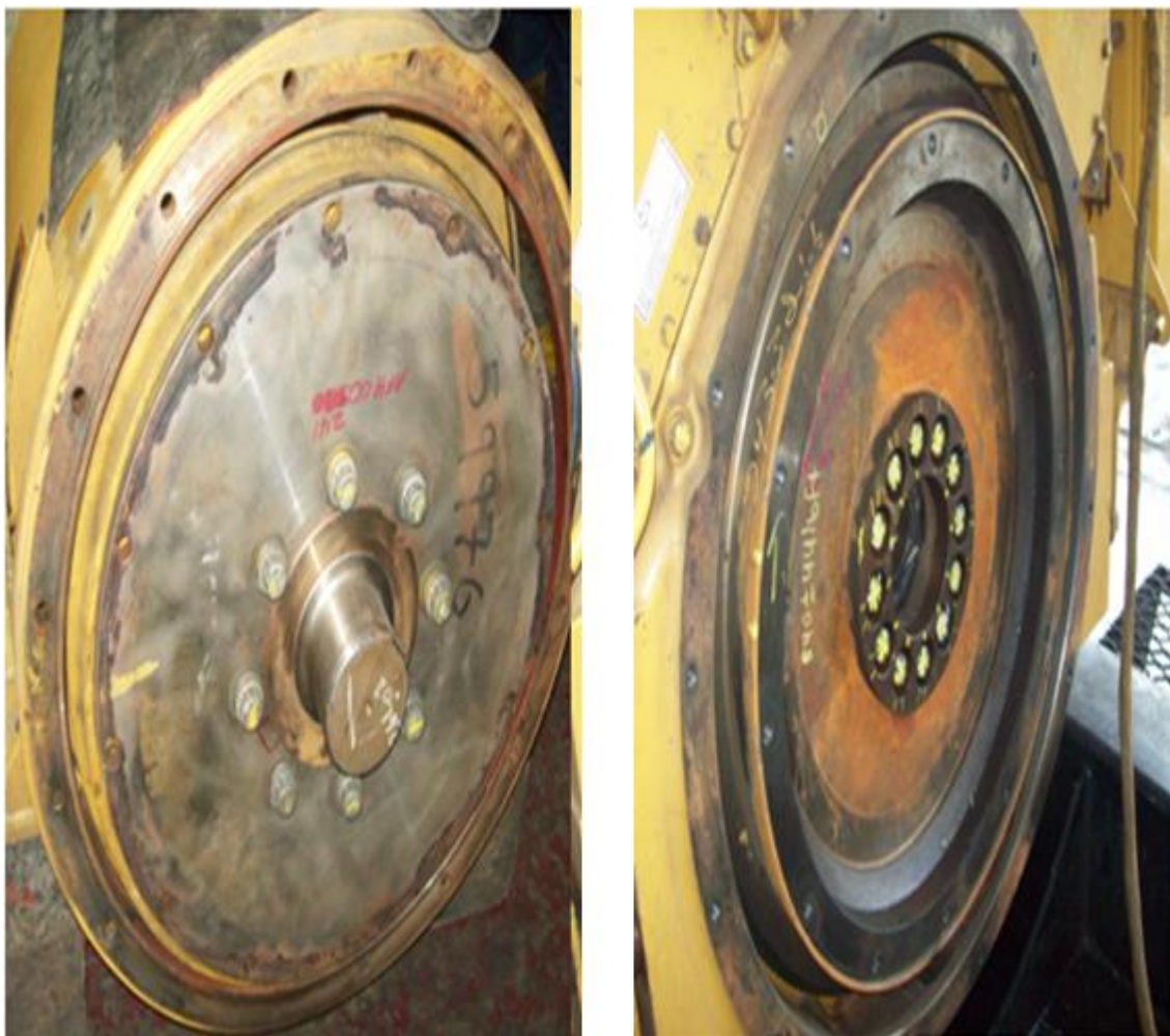
Figura 4.19: Ensamblaje Mediante Láminas
