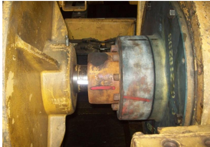
Figura 4.17: Ensamblaje Mediante un Acople
