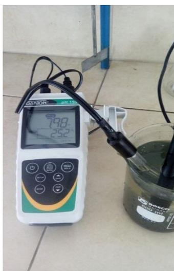
**Figura 5-3:** Muestra 2 con 10ml de  $\text{H}_2\text{O}_2$  al 30%, medición de pH
