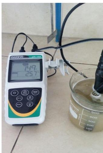
**Figura 4-3:** Medición en laboratorio de pH
