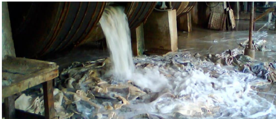
Figura 9-1: Eliminación de agua de pelambre
