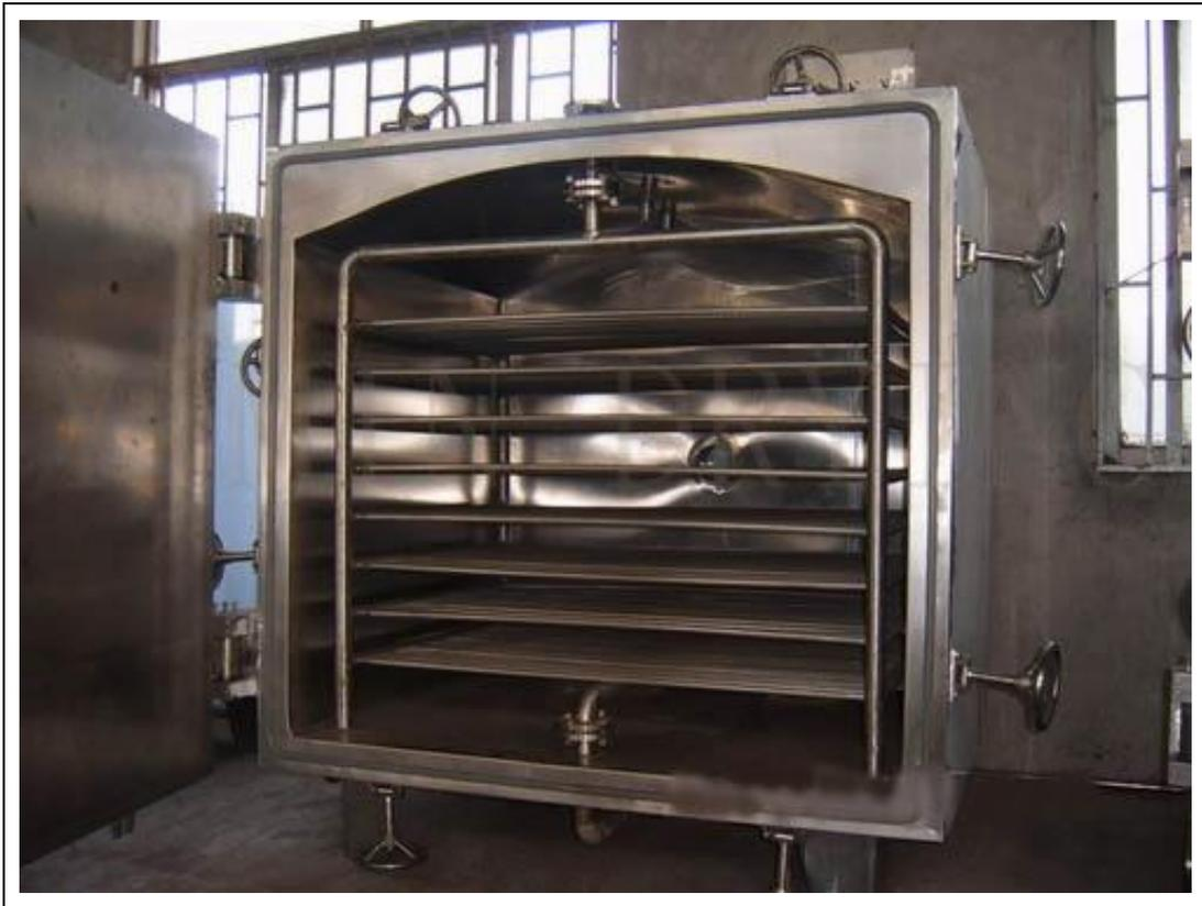
**Figura 9-1. Vista frontal de secador de bandejas.**
