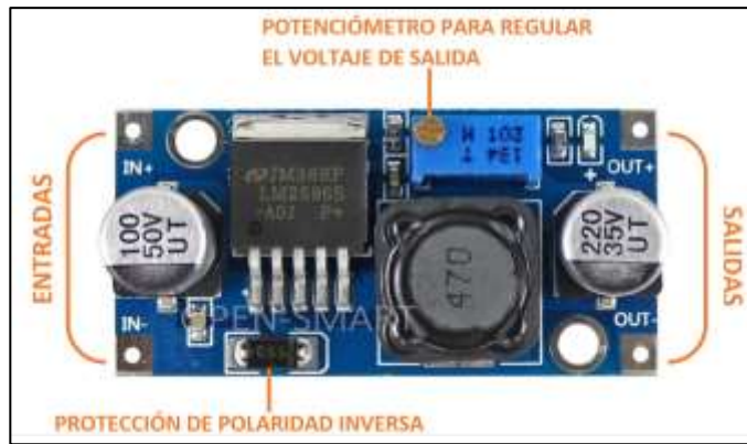
Figura 13-2 Configuración del módulo LM2596
