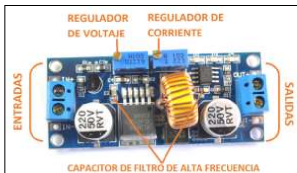
Figura 14-2 Configuración del módulo XL4015
