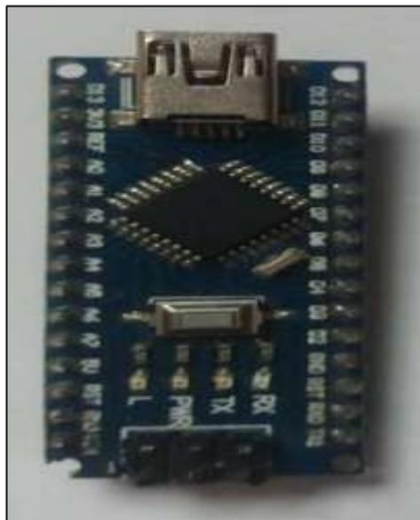
Figura 5-2 Tarjeta Arduino NANO
