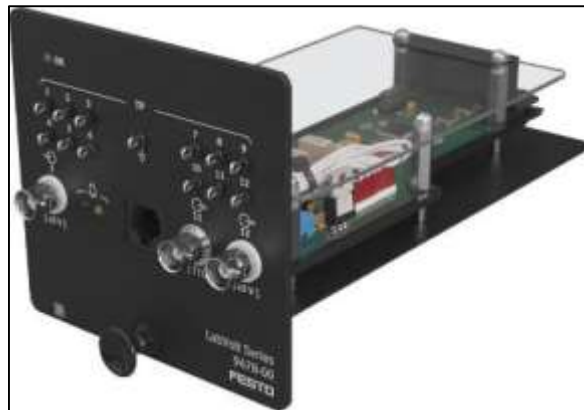
Figura 27-1. Interfaz de enlace digital modelo 9478
