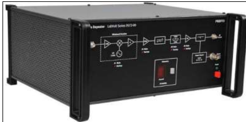
Figura 14-1. Equipo repetidor satelital, 9572.
