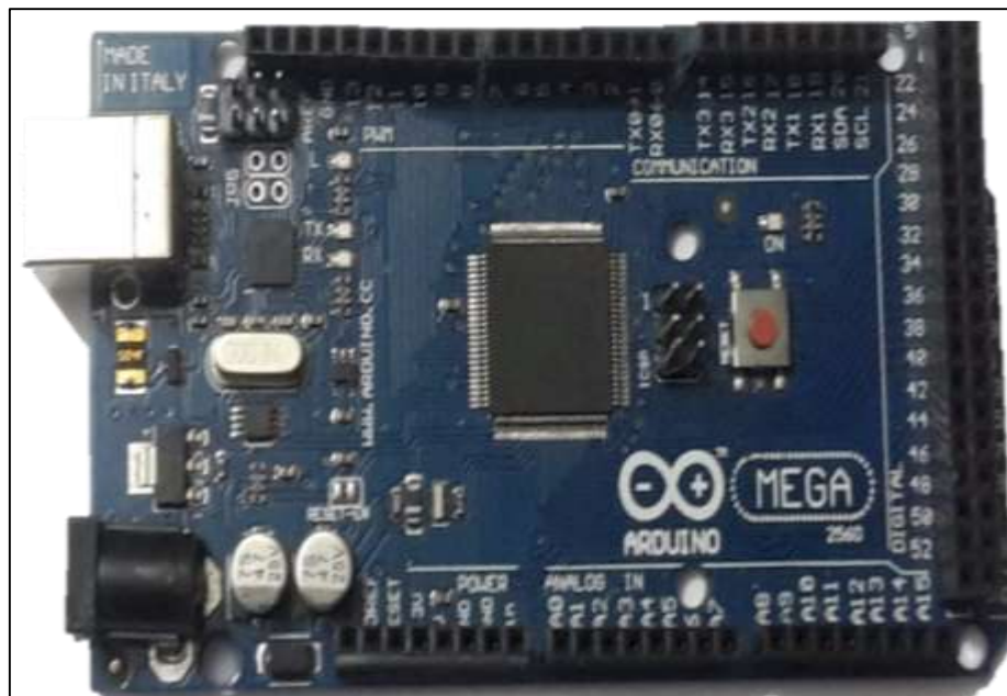
Figura 4-2: Tarjeta de desarrollo Arduino Mega2560
