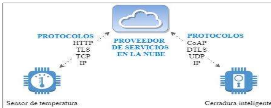
Figura 10-1: Modelo de comunicación dispositivo a internet
