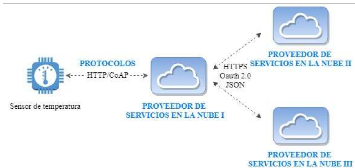
Figura 12-1: Intercambio de datos a través de Back-End
