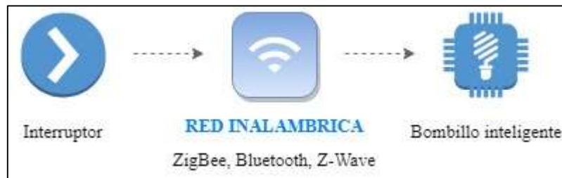
Figura 9-1: Modelo de comunicación dispositivo a dispositivo
