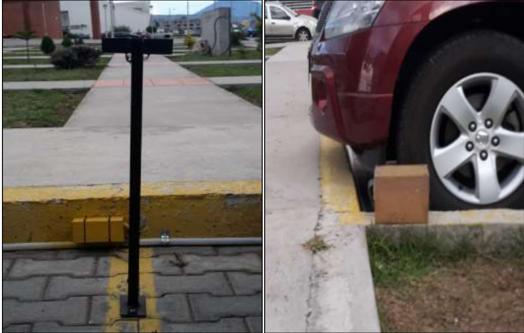
Figura 9-3: Nodo sensor (Izquierdo), Nodo Recolector (Derecho)
