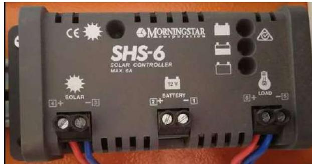
**Figura 16-2:** Controlador de carga
