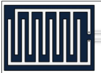
**Figura 2-1.** Placa para detección de lluvia.
