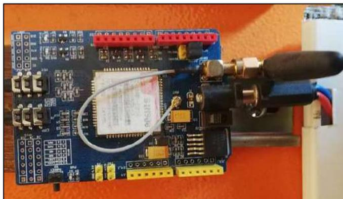
**Figura 11-2:** Módulo GPRS SIM900
