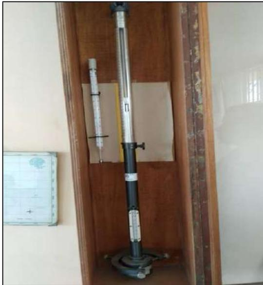
**Figura 3-3.** Barómetro clásico de mercurio
