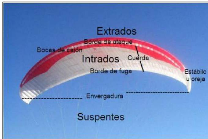
**Figura 1-1.** Partes del parapente
