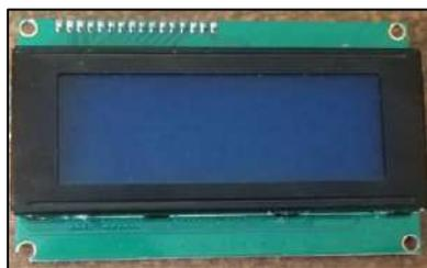
**Figura 13-2:** Módulo LCD 2004A
