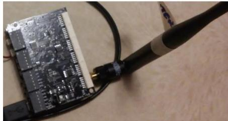
**Figura 22-3:** Colocación y ajuste de la antena (2,4GHZ)
