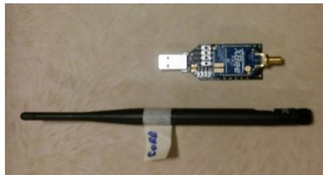
**Figura 16-3:** Montaje del XBee Pro serie1 en el Gateway USB
