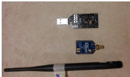
**Figura 15-3:** Módulo XBee PRO S1 con Gateway y antena
