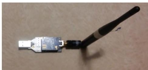
**Figura 17-3:** Montaje de la antena en la XBee PRO serie 1
