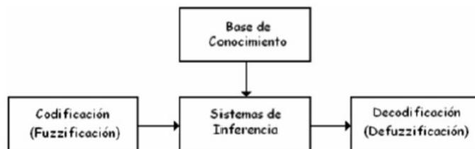
**Figura 50-3:** Estructura general de un controlador difuso
