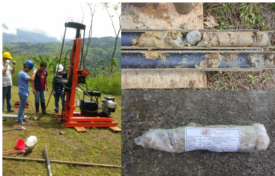
Figura 15-3: a) Ensamblado de la máquina SPT; b) Recuperación de testigo; c) Guardado y etiquetado de la muestra.
