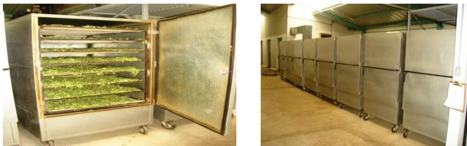
El secador tiene: dos ventiladores axiales, un quemador eléctrico y un auxiliar, esto dos para generar aire caliente, el cual pasa por un ducto que se encuentra a lado de los secadores, también hay otro ducto que pasa por la parte superior de los secadores, el cual se encarga de reciclar el aire caliente y pasarlo al área de pre secado, esto permite que no haya desperdicio de aire caliente.
