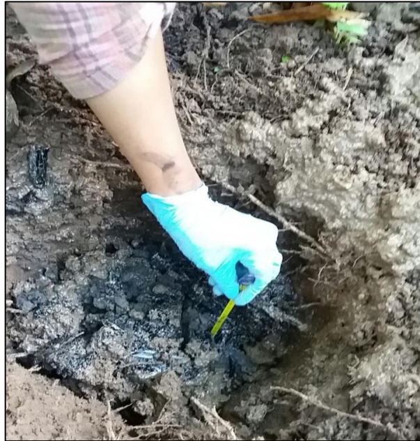
Figura 3-2: Medición de la temperatura in situ en el punto 8 sobre la piscina de desechos petroleros.
