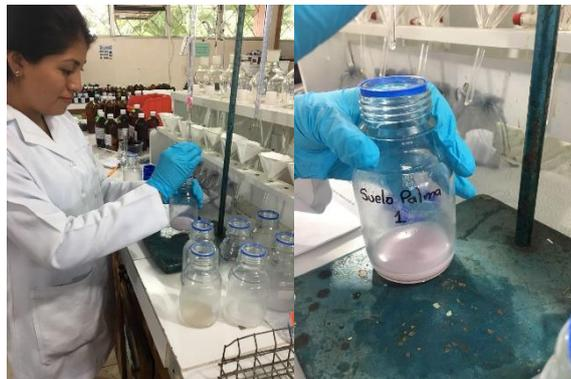
**Fotografía 8-2.** Aplicación de reactivos para la determinación del CO<sub>2</sub>
