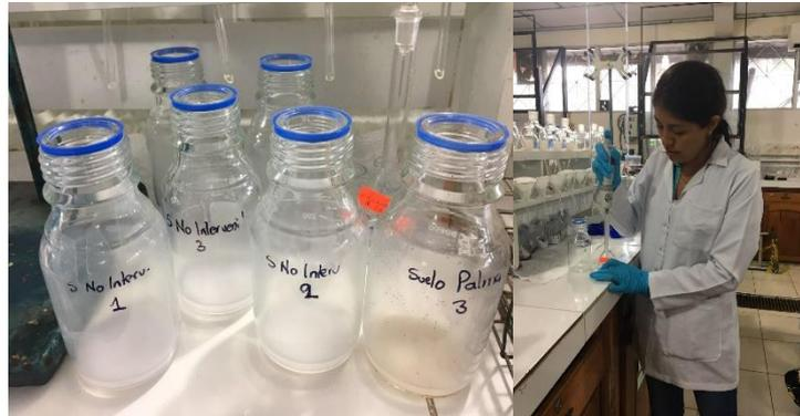
**Fotografía 9-2.** Determinación de CO<sub>2</sub> en la solución
