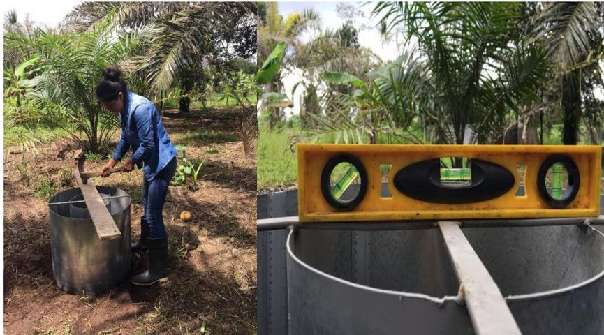
**Fotografía 4-2.** Implementación de los equipos in situ para evaluar la infiltración
