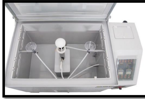
Figura 5-1. Cámara salina. Fuente: http://www.cci-calidad.com
