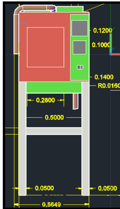
Figura 8-3. Vista frontal de la cámara de envejecimiento acelerado Realizado por: Daniela Cabezas, Enrique Mejía, 2018
