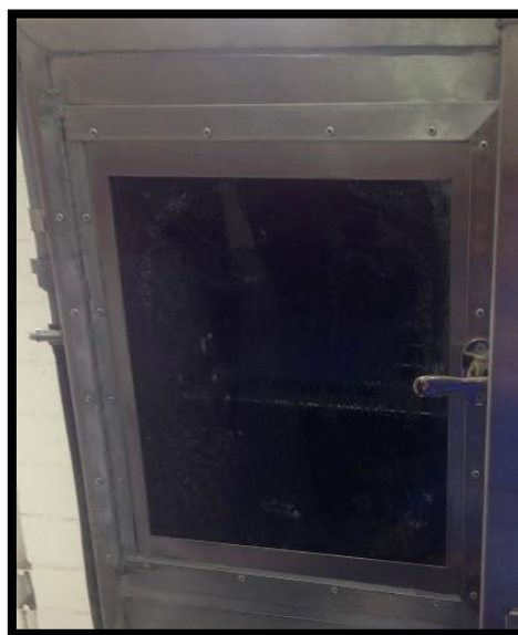
Fotografía 1-3. Puerta de la cámara de envejecimiento acelerado Realizado por: Daniela Cabezas, Enrique Mejía, 2018
