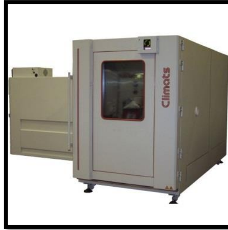
Figura 7-1. Cámara de envejecimiento debido a lluvia. Fuente: http://www.cci-calidad.com
