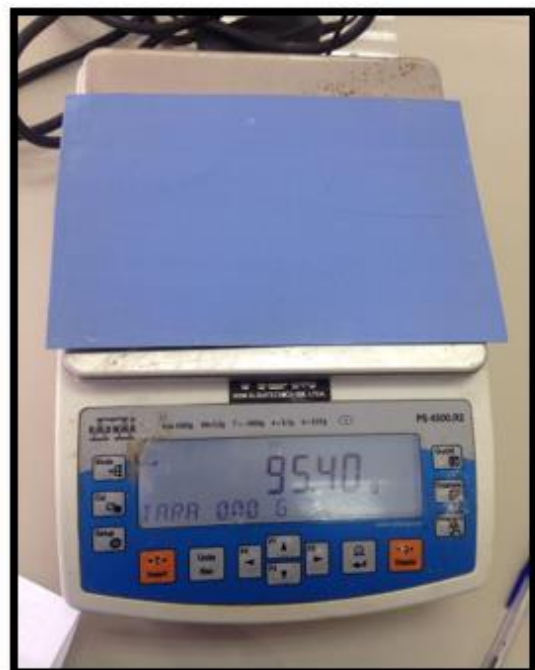
Fotografía 16-3. Diferencia de pesos antes y después de la práctica placa azul Realizado por: Daniela Cabezas, Enrique Mejía, 2018
