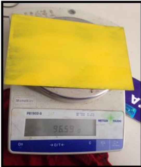
Fotografía 15-3: Diferencia de pesos antes y después de la práctica placa amarilla Realizado por: Daniela Cabezas, Enrique Mejía, 2018
