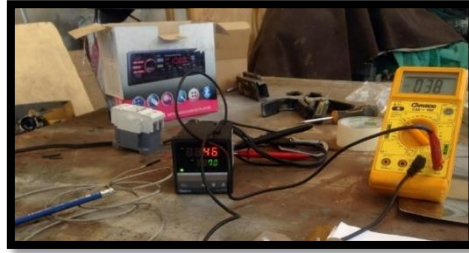
Fotografía 5-3. Calibración del termostato Realizado por: Daniela Cabezas, Enrique Mejía, 2018
