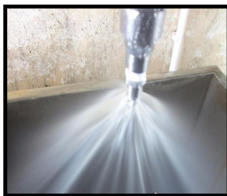
Fotografía 2-3 Aspersor de agua de la cámara de envejecimiento acelerado
