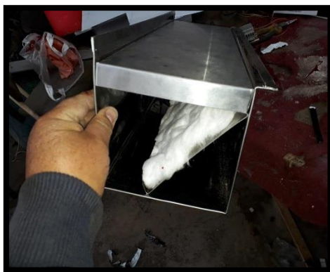
Fotografía 6-3: Lana de vidrio en las cajas de lámparas Realizado por: Daniela Cabezas, Enrique Mejía, 2018
