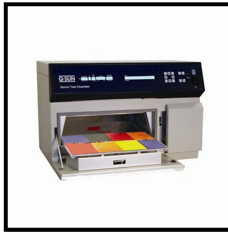
Figura 4-1. Cámaras de envejecimiento solar. Fuente: http://www.cci-calidad.com
