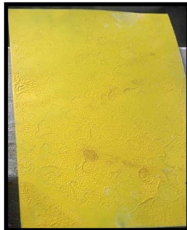
Fotografía 21-3. Resultado de herrumbramiento de la placa amarilla
