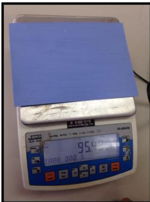
Fotografía 16-3. Diferencia de pesos antes y después de la práctica placa azul Realizado por: Daniela Cabezas, Enrique Mejía, 2018
