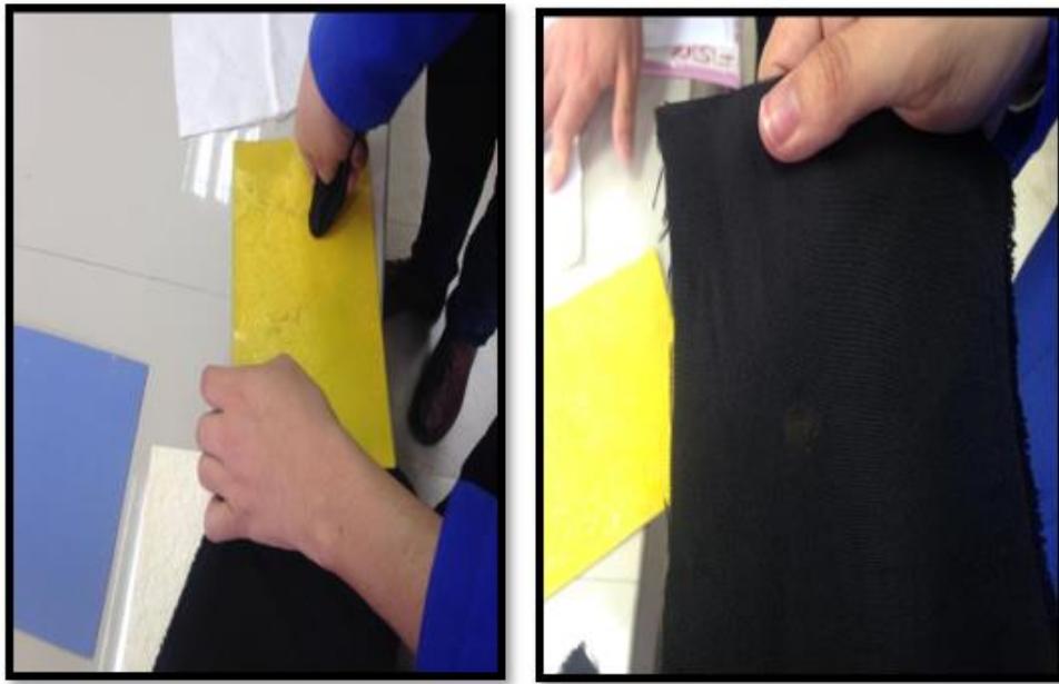
Fotografía 18-3. Prueba de Caleo de la placa amarilla Realizado por: Daniela Cabezas, Enrique Mejía, 2018
