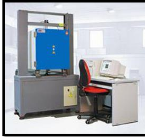
Figura 2-1 . Cámaras criogénicas bajo tensión Fuente: CCI, catálogo criogenia bajo tensión
