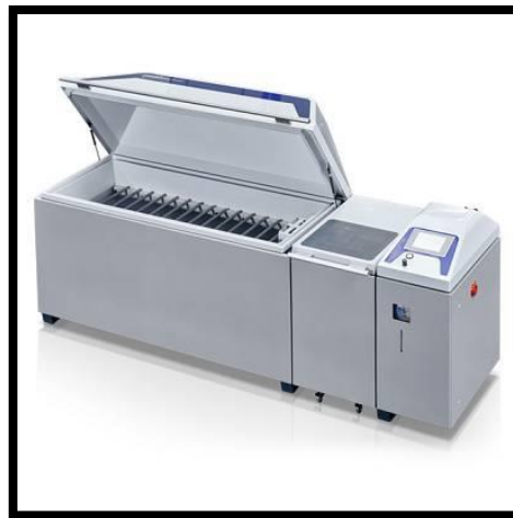
Figura 3-1. Cámaras de corrosión cíclicas. Fuente: Q-Lab, Disponible en: https://www.q-lab.com
