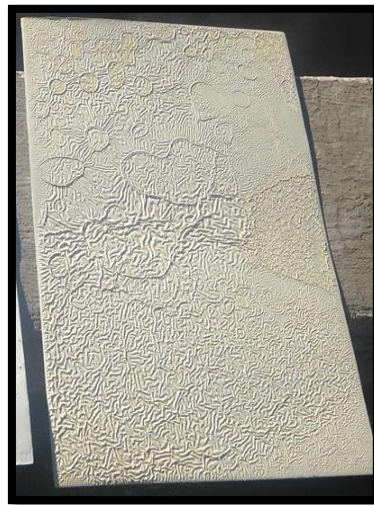
Fotografía 26-3. Resultado del ampollamiento placa blanca Realizado por: Daniela Cabezas, Enrique Mejía, 2018
