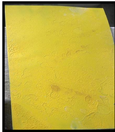
Fotografía 24-3. Resultado del ampollamiento placa amarilla
