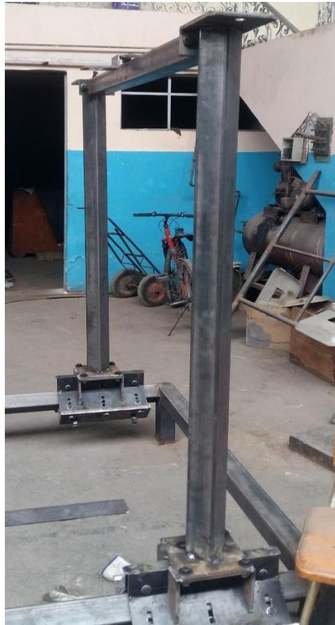
Figura 3-15: Riel Z y Viga Pórtico Vertical.
