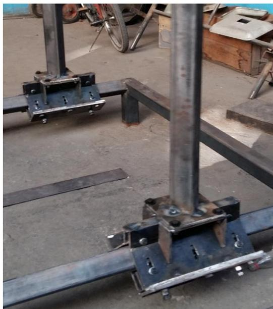
Figura 3-12: Carro deslizamiento y soporte riel Z.
