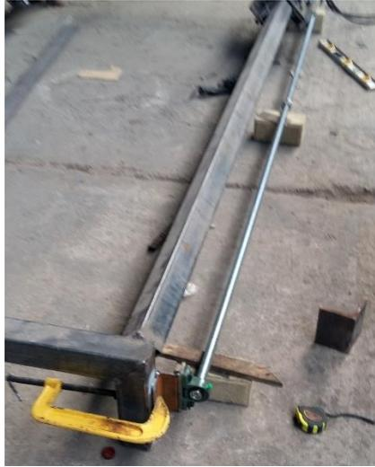
Figura 3-20: Colocación de los ejes roscados Y.
