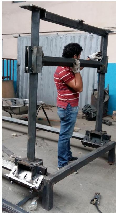
Figura 3-17: Construcción Carro deslizamiento Z y Riel X.
