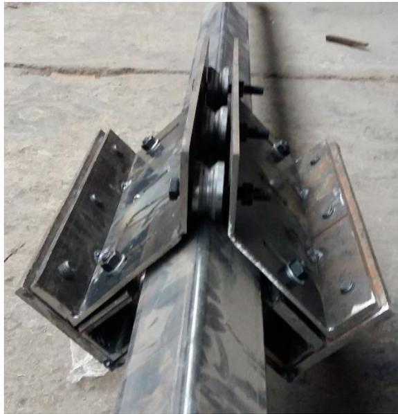
Figura 3-11: Carro deslizamiento en Y.
