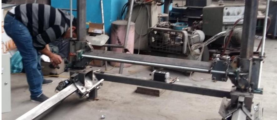
Figura 3-22: Instalación del eje X.
