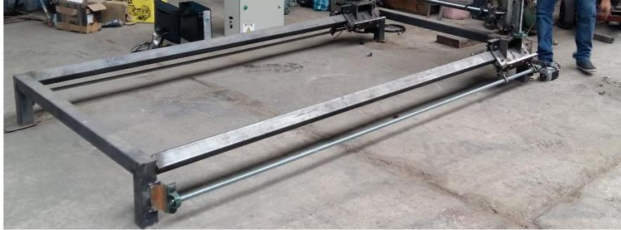
Figura 3-9: Construcción de la mesa de soporte y riel Y.
