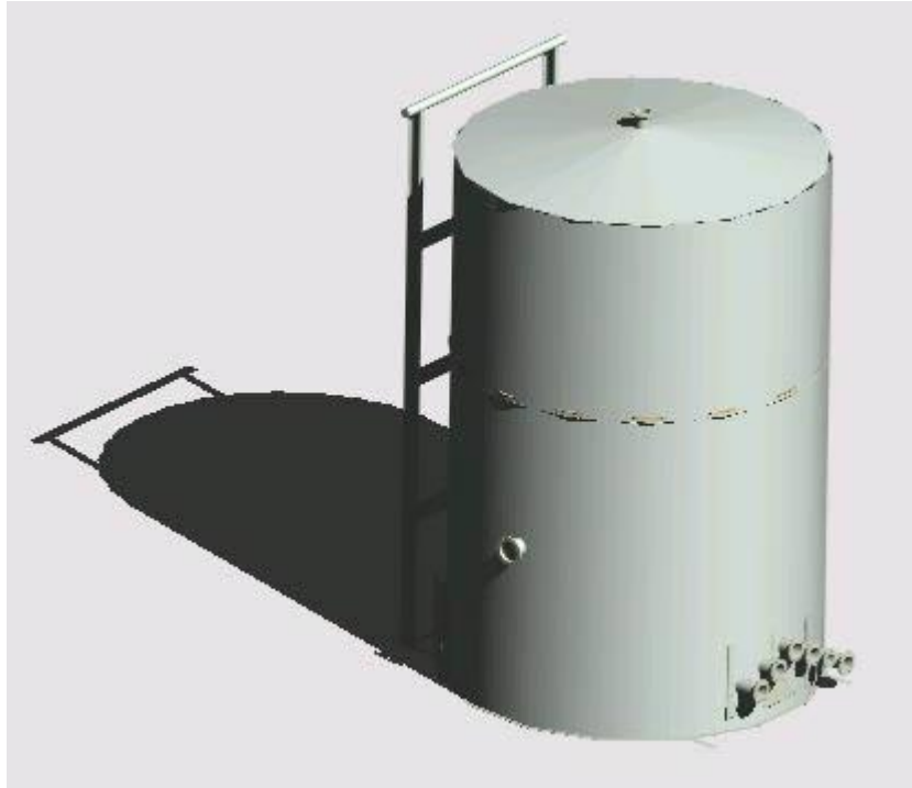
Figura 12-15: Tanque de lavado
