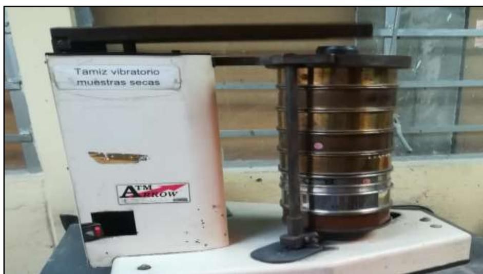
**Fotografía 1-3** Torre de tamices Tyler con un sistema de agitación Rot-Tap
