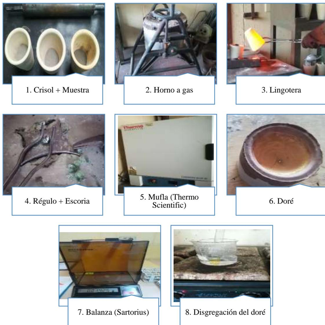
**Figura 1-3** Esquema del análisis por ensayo al fuego
