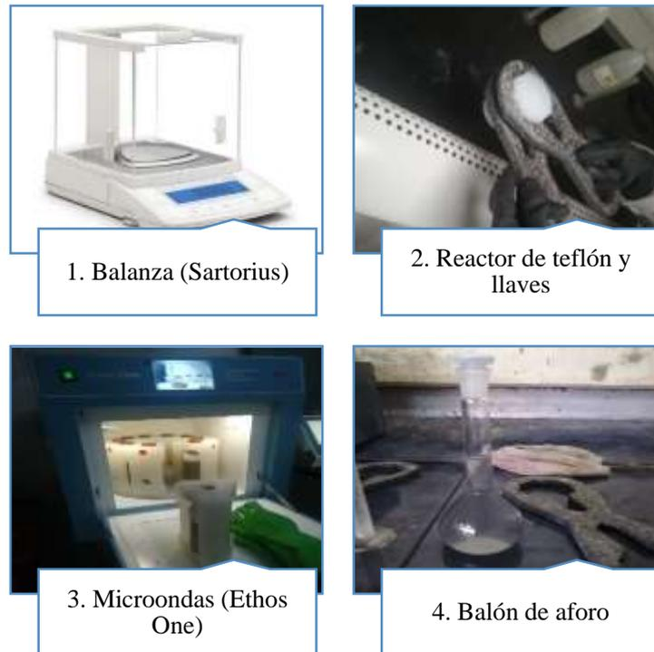
**Figura 2-3** Esquema gráfico de disgregación ácida
