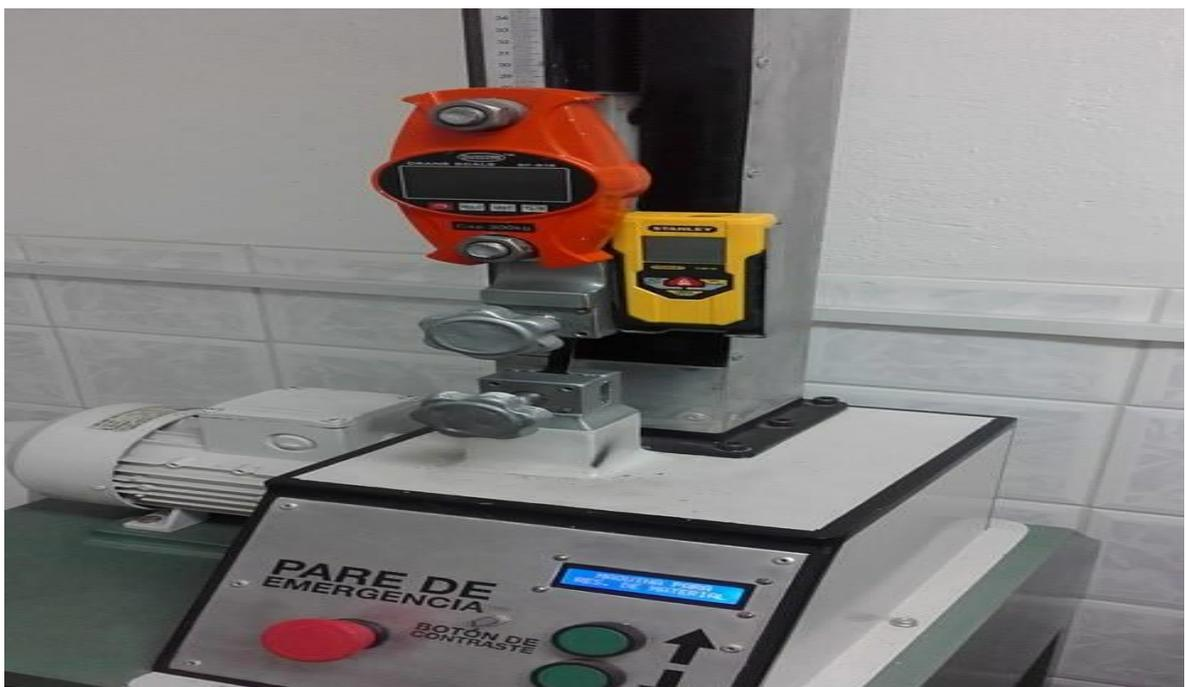
Fotografía 3. Equipo para realizar la medición de la resistencia a la tensión.
