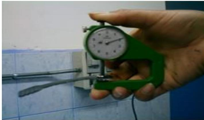
Fotografía 4. Equipo para medir el calibre del cuero.
