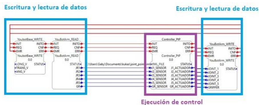
Figura 19-3: Aplicación de Control Distribuido en 4DIAC-IDE
