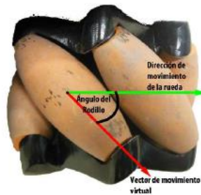
Figura 13-2: Descripción de la rueda tipo Mecanum
