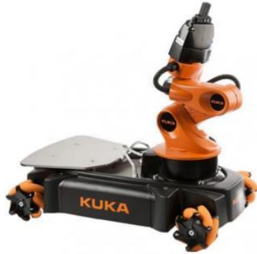
Figura 8-2: Manipulador Móvil Omnidireccional Brazo KUKA youBot
