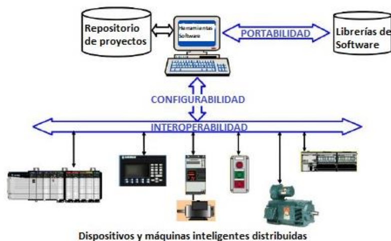
Figura 2-2: Esquema de los objetivos de la norma IEC-61499 para el SCD
