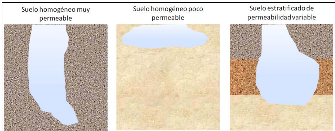
Figura 2-1: Propagación de un vertido contaminante en función de la estratificación del suelo.
